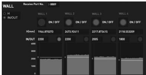
図 9 測距センサーの閾値の設定画面。一番左のセンサー（WALL 1）だけ閾値を越えている（＝チンパンジーが壁に近づいている）状態を表している。
